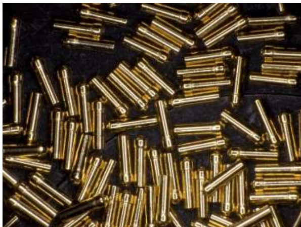
材質：C3604 下地めっき：無電解ニッケル 最終めっき：硬質金（Au-Co）
