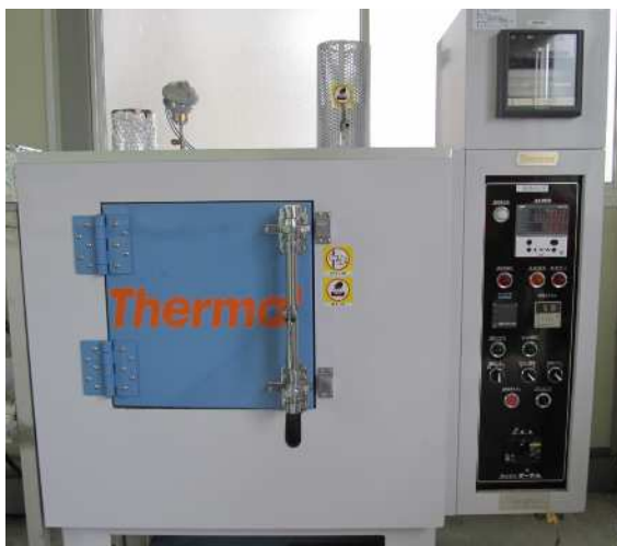
（株）サーマル社製 RON4/K 用途：ベリリウム銅の時効硬化処理（MAX600℃）
